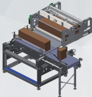
El traslado de las filas se realiza a través de una barra motorizada. La fila formada se lleva directamente al cabezal de toma (cesto). El sistema está equipado con una bûfer de acumulación que permite seguir con la introducción de las filas incluso cuando el cabezal no está en posición de toma.
