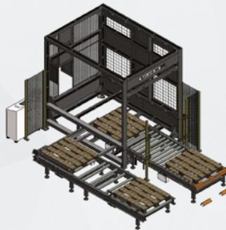
Protecciones con red instaladas a bordo de la máquina, excepto en el área de carga/descarga del palet donde son fijas al suelo. Hay una descarga para el pasaje del palet en el área de carga de palets vacíos y barreras ópticas con dispositivo de silenciamiento para la salida del palet lleno.
