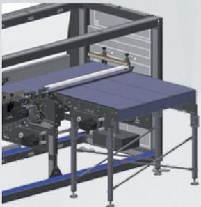
El traslado de las filas se realiza a través de una barra motorizada. La fila formada se lleva directamente al cabezal de toma (cesto). El sistema está equipado con un búfer de acumulación que permite seguir con la introducción de las filas incluso cuando el cabezal no está en posición de toma.
