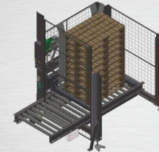
Es disponible como accesorio opcional el almacén palets vacíos con rodillos integrados. El área de elevación de los palets es manejado por cilindros neumáticos. La capacidad máxima de este dispositivo es de aproximadamente 300 kg (12 palets 1000x1200 mm).
