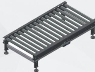
Estructura de acero pintado y rodillos  $\varnothing$  76 mm paso 150 mm, motorizados mediante cadena de 5/8 de pulgada. Motorización central reversible electrónicamente. El sistema es probado por SMI y entregado al cliente completamente montado y cableado. Disponibles en diversas longitudes de 1500 mm, 2000 mm, 2500 mm y 3000 mm.
