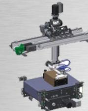
En el APS 1570 la rotación de paquetes también puede realizarse a través de un manipulador motorizado (dispositivo opcional).
