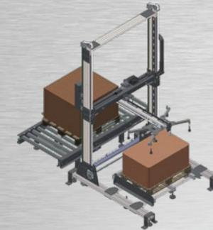
Sistema de alimentación de la planchas ajustable en función de las diversas dimensiones del Inter-pad que puede trabajar en conjunto con la columna central del paletizador APS ERGON. El sistema de toma con ventosas de 4 a 8 puntos ajustables para garantizar el correcto levantamiento de cualquier tipo de intercalar. La carga automatizada de planchas
