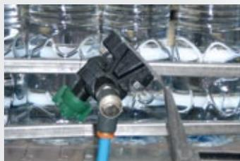
L'impianto di lubrificazione dei nastri Smiline è un sistema automatico ad ugelli che permette di ridurre drasticamente il livello di rumorosità, i costi di esercizio e gli interventi di pulizia. L'impianto di
