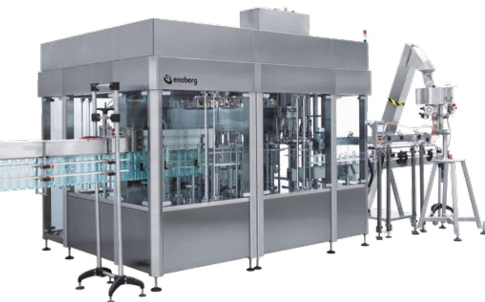
remplissage et auto-nivellement). Dotée d'un réservoir adapté pour résister à des pressions pouvant atteindre 6 bars, la remplisseuse ENBERG de la série ELC couvre une vaste gamme de productions, grâce à la configuration de 5 à 48 robinets de remplissage.
