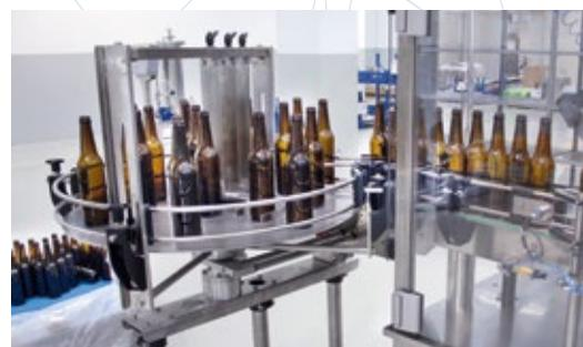
ossigeno, le bottiglie sono portate alla stessa pressione del serbatoio prodotto per permettere il riempimento per gravità. Quando il prodotto raggiunge il livello
