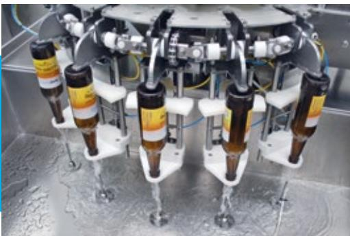
del tubo di sfiato, la valvola si chiude pneumaticamente ed ha inizio la fase di decompressione, che riporta la bottiglia alla pressione ambiente senza agitare il liquido riempito.
