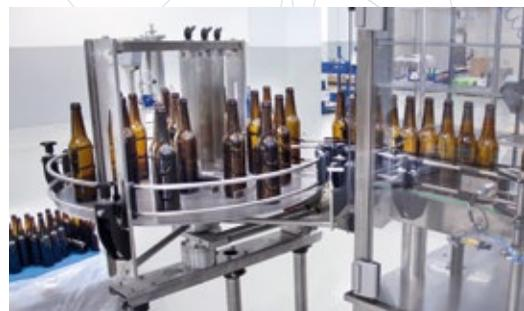
les bouteilles sont amenées à la même pression que le réservoir de produit pour permettre le remplissage par gravité.
