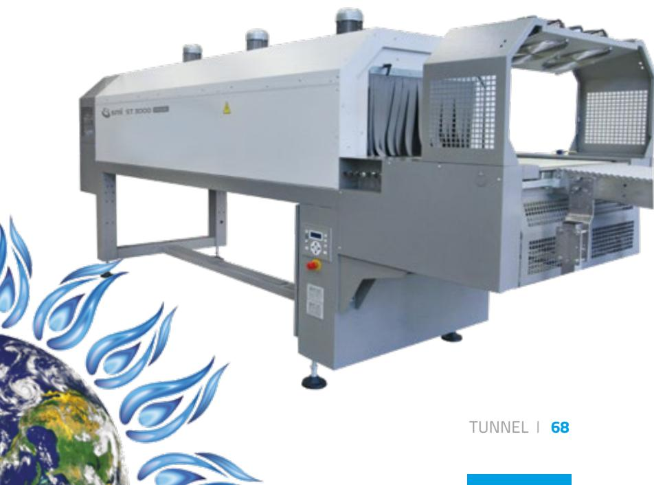
dans la version électrique ou au méthane, où la chaleur nécessaire à la thermorétraction des paquets en transit s'obtient par la combustion de méthane plutôt que par le chauffage de résistances électriques ad hoc.
