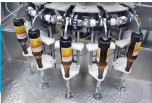
Quand le produit atteint le niveau du tuyau d'évent, la soupape se ferme pneumatiquement et la phase de décompression débute, qui remet la bouteille à la pression ambiante sans agiter le liquide rempli.
