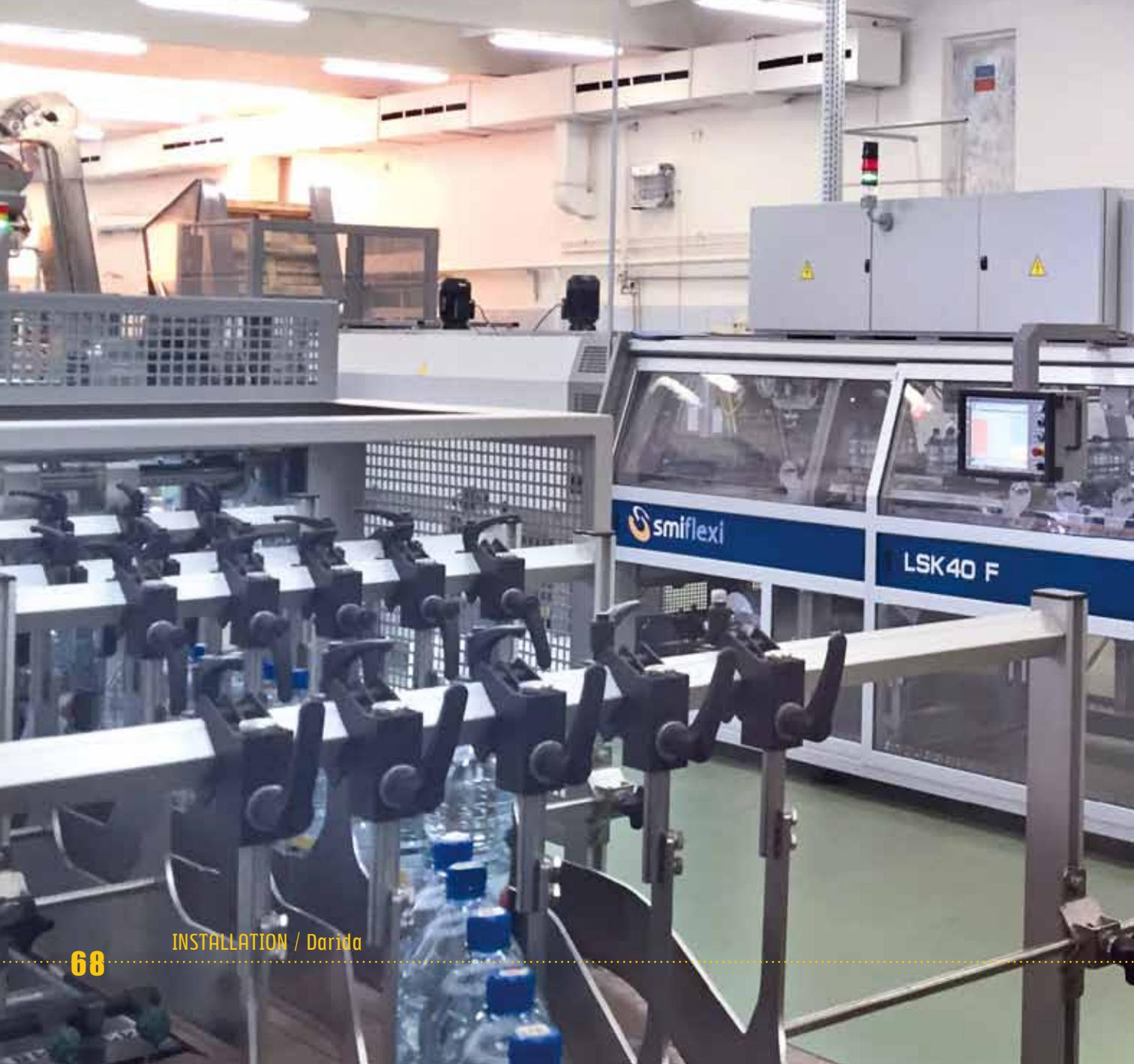
refrigerazione, è in grado di sfruttare le basse temperature esterne della regione di Minsk, riducendo il carico termico del sistema frigorifero e, conseguentemente, l'energia elettrica utilizzata per il suo funzionamento. Il processo di imbottigliamento è basato su un sistema integrato ECOBLOC® 6-66-8 HP LG-VMAG Smiform per lo stiro-soffiaggio, il riempimento e la tappatura di bottiglie cilindriche e a
