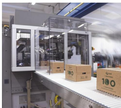
**L**a riduzione dei tempi di cambio formato e, conseguentemente, il miglioramento delle prestazioni operative della macchina, sono assicurati da un innovativo sistema di separazione prodotti dall'alto.
