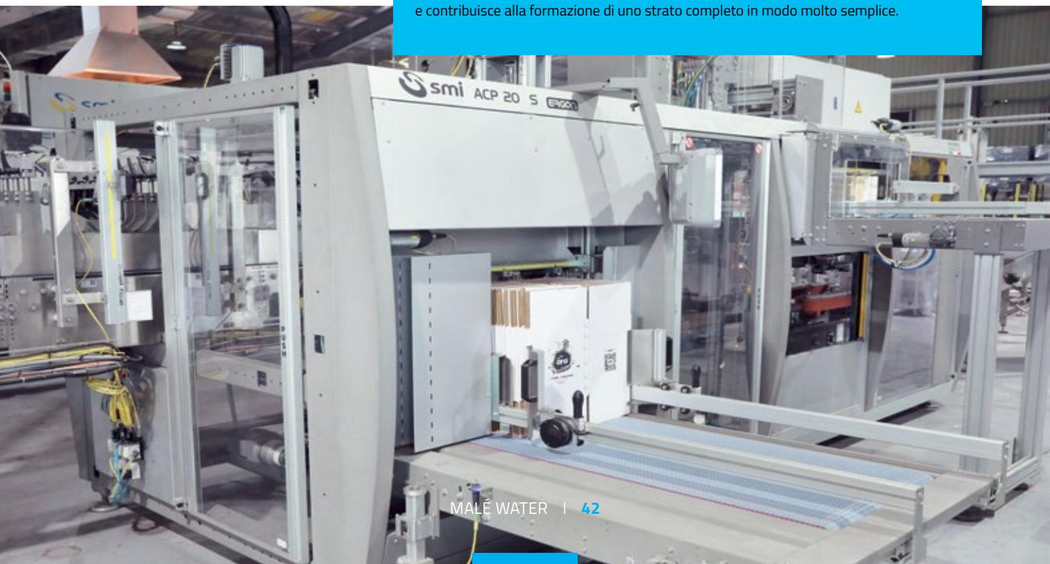
➤ **CARTONATRICE ACP 20 S ERGON con dispositivo per inserimento separatori**
