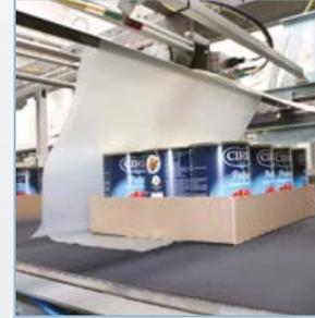
**1** Un sistema con entrada de una fila facilita la correcta canalización de envases sueltos sobre una cinta transportadora. El sistema de entrada se caracteriza por un ciclo continuo y la formación del paquete se efectúa por un sistema de separación de producto de doble correa controlado por eje electrónico.
