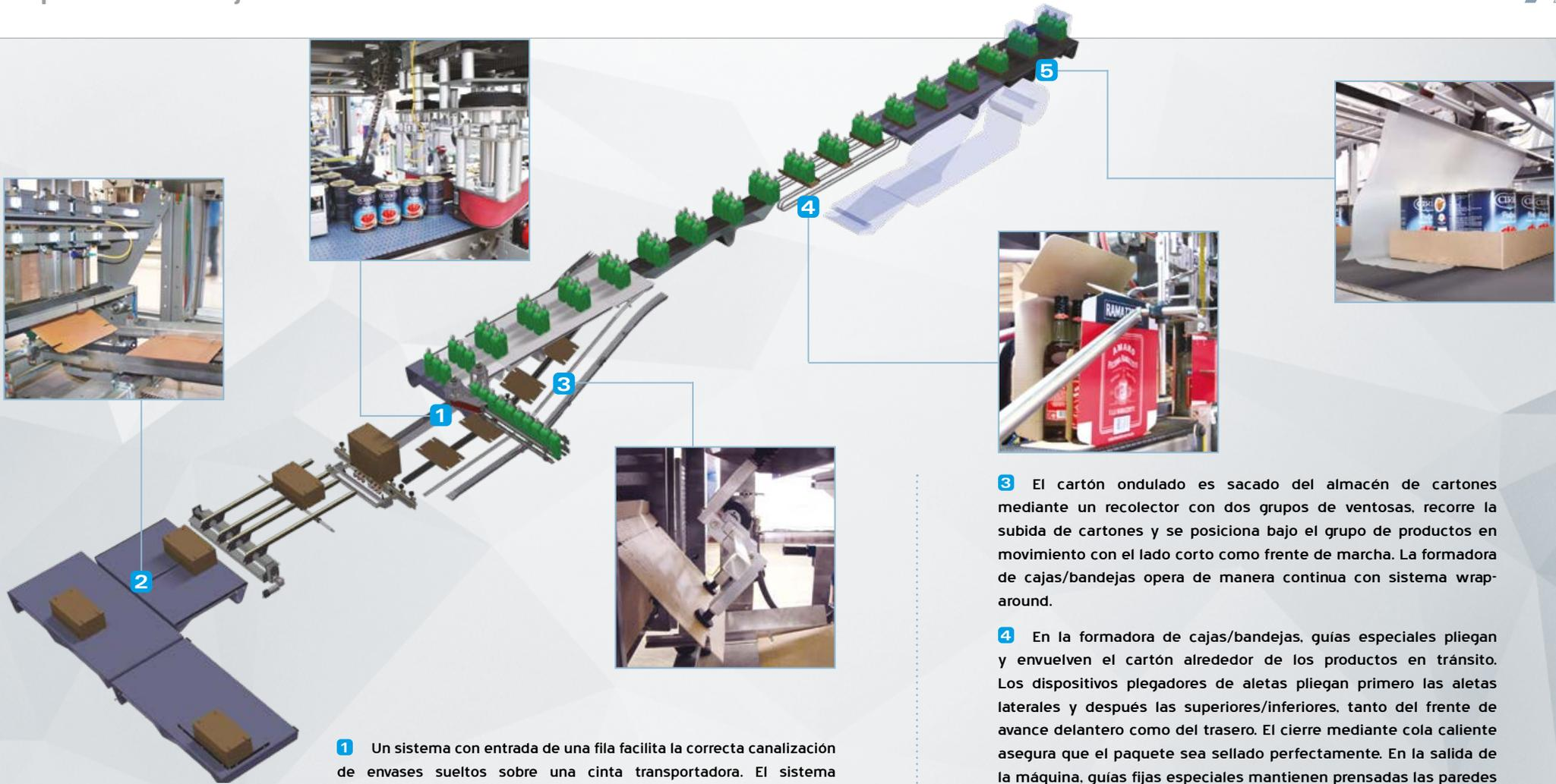
**1** Un sistema con entrada de una fila facilita la correcta canalización de envases sueltos sobre una cinta transportadora. El sistema de entrada se caracteriza por un ciclo continuo y la formación del paquete se efectúa por un sistema de separación de producto de doble correa controlado por eje electrónico. Posteriormente, gracias a un sistema de tipo giratorio, los productos sueltos se mueven desde la cinta transportadora de entrada a la cinta transportadora de empaque.
