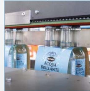
**1** En la cinta de entrada de la máquina, equipada con cadenas de material termoplástico de bajo coeficiente de fricción, los envases sueltos ya llegan canalizados en 1 o 2 filas.
