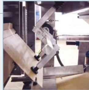
**3** El cartón ondulado es sacado del almacén de cartones mediante un recolector con dos grupos de ventosas, recorre la subida de cartones y se posiciona bajo el grupo de productos en movimiento con el lado corto como frente de marcha. La formadora de cajas/bandejas opera de manera continua con sistema wrap-around.
