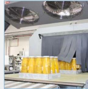
**1** En la zona de entrada de la máquina, un separador oscilante motorizado canaliza correctamente los envases sueltos, conducidos por medio de una cinta transportadora con cadenas de material termoplástico de bajo coeficiente de fricción. En la zona de formación del paquete, los envases se agrupan en el formato requerido mediante un dispositivo neumático (LCM 30) o electrónico (LCM 40).
