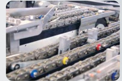
POSYC, mientras que las regulaciones mecánicas del separador de productos, de la subida de cartones, de la formadora de bandejas/cajas y del envolvedor del film son simples e intuitivas, gracias a indicadores de posición de color posicionados sobre las cadenas.
