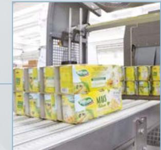
**1** En la cinta de entrada de la máquina, un grupo de guías oscilantes motorizadas canaliza correctamente los recipientes sueltos hacia el área de formación del paquete.
