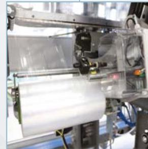
**1** En la zona de entrada de la máquina, un separador oscilante canaliza correctamente los envases sueltos, conducidos por medio de una cinta transportadora con cadenas en material termoplástico de bajo coeficiente de fricción. En la zona de formación del paquete, los envases se agrupan de manera alternada en el formato requerido mediante un dispositivo neumático y barras de compensación sincronizadas electrónicamente.
