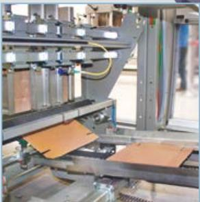
**1** Un sistema con entrada de una fila facilita la correcta canalización de envases sueltos sobre una cinta transportadora. El sistema de entrada se caracteriza por un ciclo continuo y la formación del paquete se efectúa por un sistema de separación de producto de doble correa controlado por eje electrónico. Posteriormente, gracias a un sistema de tipo giratorio, los productos sueltos se mueven desde la cinta transportadora de entrada a la cinta transportadora de empaque.
