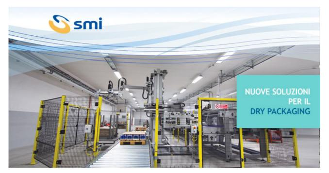
I nuovi palettizzatori APS di SMI per l'imballaggio terziario di fine linea (dry packaging) fino a 100 pacchi/minuto sono progettati e costruiti secondo la nuova piattaforma ERGON, dove l'ergonomia e l'integrazione avanzata degli impianti consentono di realizzare linee di imbottigliamento "cost-saving" studiate per ridurre i costi di produzione, accrescere il risparmio energetico ed ottimizzare l'efficienza di funzionamento dell'intero sistema.
