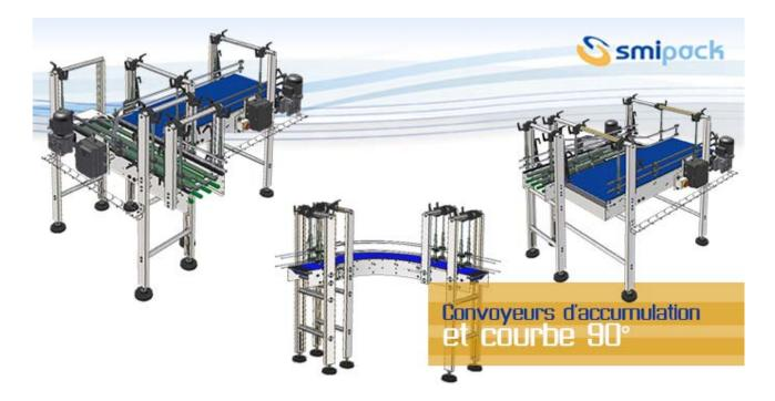
Pour les modèles en ligne avec barre de soudure (BP AL) et à lancement de film (BP ALX) Smipack a étudié des solutions dédiées pour l'accumulation des produits avant les fardeleuses et pour offrir une connexion plus facile des lignes des clients à nos BP.
