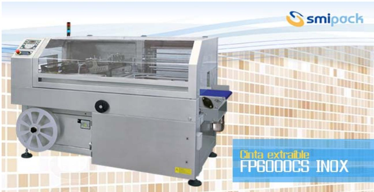
Las nuevas versiones de las empaquetadoras automáticas FP6000/CS INOX serán dotadas en su versión estándar con una cinta de entrada extraíble que permite una mejor limpieza de las partes que entran en contacto con los productos alimentarios embalados con nuestras empaquetadoras.
