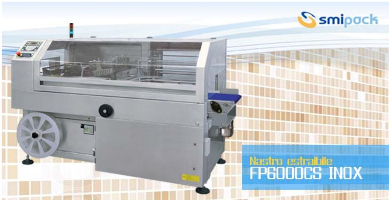
Le nuove versioni delle confezionatrici automatiche FP6000/CS INOX saranno dotate come fornitura standard di un nastro d'ingresso estraibile che permette un'agevole pulizia delle parti che vengono a contatto con i prodotti alimentari imballati con le ns. confezionatrici.
