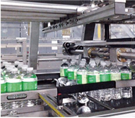
Il nuovo "Bee-hive Pack" è realizzato dalle **fordellatrici in film termoretraibile Smiflexi della serie LSK/SK** e dalle **cartonatrici wrap-around Smiflexi della serie WP**, appositamente dotate di uno specifico dispositivo che dispone i contenitori (bottiglie o lattine) in file "sfalsate" in modo alternato e le mantiene tali durante l'intero processo di formazione del pacco.
