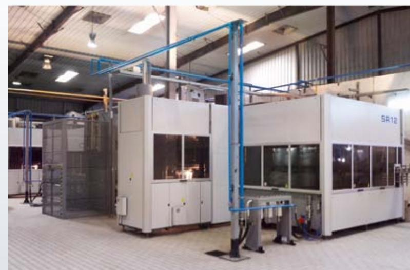
sono stati realizzati da Smimec, un'altra società del Gruppo SMI, utilizzando una sofisticata linea di produzione FMS composta da 12 centri di lavoro CNC. Questi ultimi sono macchine utensili tecnologicamente avanzate e completamente automatizzate, che funzionano 24 ore/24, 7 giorni la settimana, anche in assenza di operatori.
