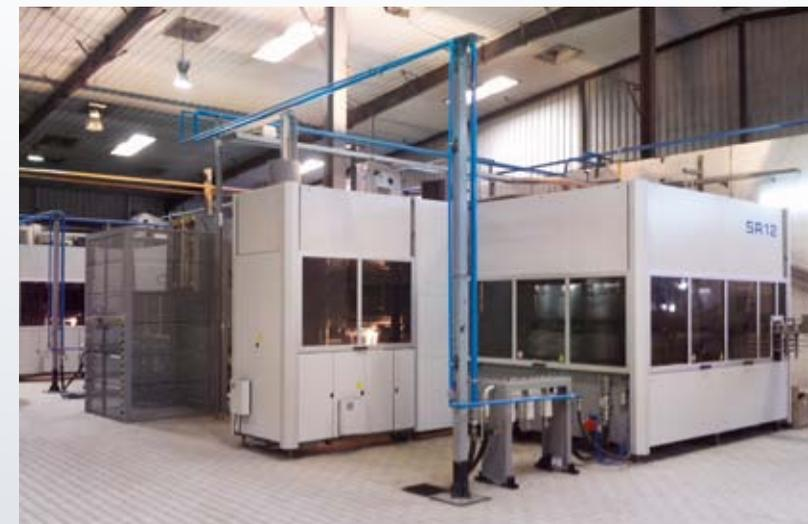
bouteille commercialisés par les deux entreprises yéménites; ces moules ont été réalisés par Smimec, une autre société du Groupe SMI, en utilisant une ligne de production FMS sophistiquée formée de 12 centres d'usinage CNC. Il s'agit de machines-outils d'avant-garde sur le plan technologique et tout à fait automatisées, qui fonctionnent 24 heures sur 24, 7 jours par semaine même en l'absence d'opérateurs.
