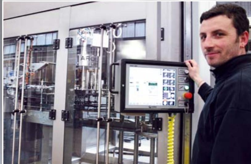
L'imballaggio primario dell'acqua minerale Oasis di Antigua Distillery in contenitori PET da 0.35 L, 0.65 L e 1,5 L è affidato al sistema integrato di stiro-soffiaggio, riempimento e tappatura ECOBLOC® 4-28-8 LG-VMAG di Smiform, mentre quello secondario in pacchi in film termoretraibile con e senza falda piana di cartone è eseguito da una fardellatrice Smiflexi modello LSK 25 P.
