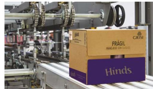
➤ **ENCARTONNEUSE WRAP-AROUND LWP 30 - cadence jusqu'à 30 paquets par minute**
