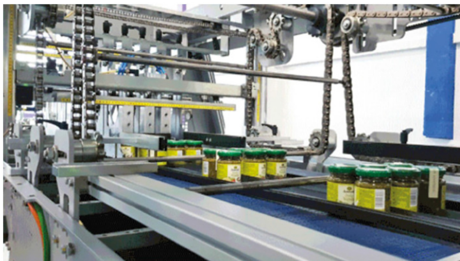
Particolare della fardellatrice a film termoretraibile LSK 40 T installata presso Cereal Terra (SMI).
