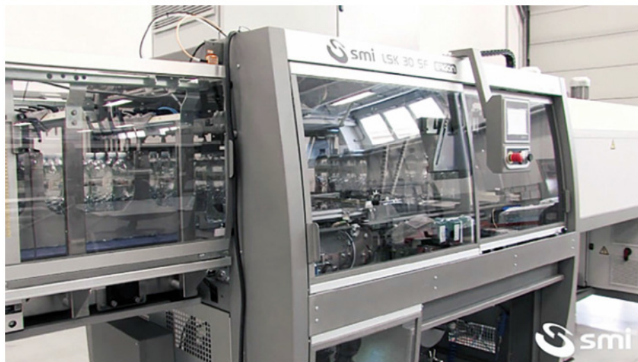
Fardellatrice automatica LSK 30 SF Ergon (SMI).
