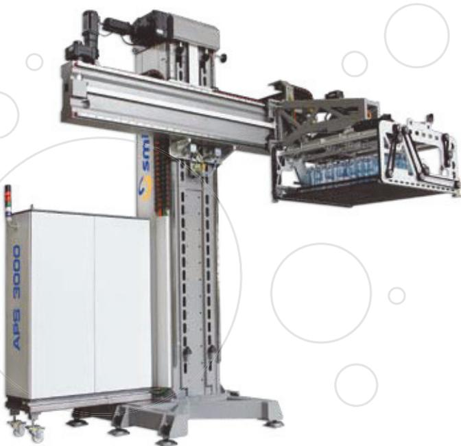
La serie APS consta de sistemas automatizados para la paletización de cartones, fardos, bandejas y paquetes en general.
