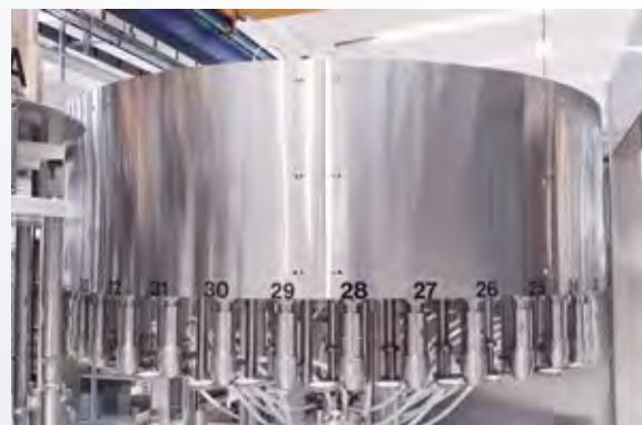
controllo elettronico delle operazioni. Anche i tempi di predisposizione della macchina al lavaggio sono ridotti al minimo, grazie all'utilizzo di false bottiglie integrate nella valvola stessa. Il modulo di riempimento e tappatura dei sistemi ECOBLOC® ERGON K vanta un nuovo design caratterizzato da un telaio modulare, senza saldature e provvisto di porte di accesso alla macchina realizzate in vetro temprato, altamente resistente e durevole nel
