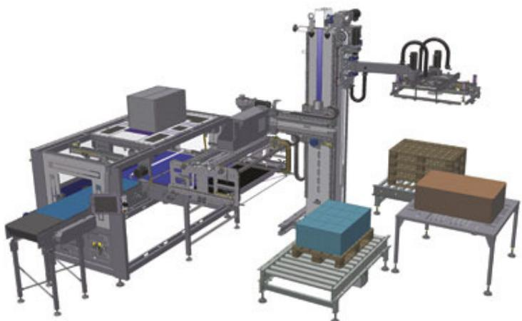
snodabile a tecnologia SCARA, che esegue movimenti sia verticali che orizzontali per le operazioni di alimentazione bancali vuoti e inserimento interfalde.
