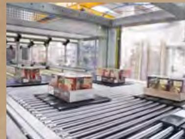
con prelievo e movimentazione dall'alto. A valle del sistema di palettizzazione è installato un avvolgitore palette dotato di un dispositivo che, prima dell'avvolgimento del film estensibile, applica degli angolari di cartone al fine di rinforzare il pallet e
