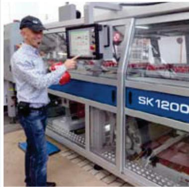
cinta transportadora compuesta por dos módulos de 2 metros cada uno, y ambos módulos están provistos de doble motorización. Además, las enfardadoras Smiflexi SK 1200/
