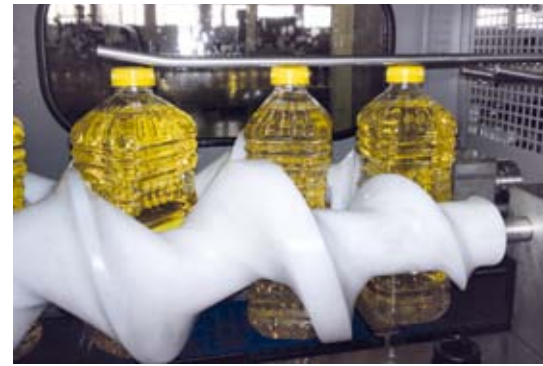
上图: DV500入口处的新装置, 通过安装在需要位置上的手柄进行理瓶。
