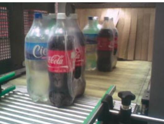
années dans les différents points de vente; la nouveauté de ce projet consiste dans l'automatisation de l'emballage, exécuté manuellement auparavant. A cet effet, SMI a conçu un système de convoyeurs à l'entrée de la fardeleuse LSK pour canaliser les bouteilles en fonction du goût, alors qu'à la sortie a été installé un tronçon de convoyeurs à galets pour garantir le refroidissement du paquet avant la palettisation manuelle.
