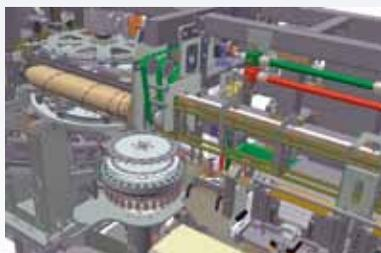
由于采用了上述的创新技术，安装在HSR系列新型Smiform拉伸吹瓶机上的瓶坯加热系统能够提高PET的加热深度、优化瓶坯通风、实现温度轮廓曲线的更大纵向均匀度，并最终实现整个工艺过程的24.1%的光热性能，远远高于普通加热系统所能实现的10.5%。
