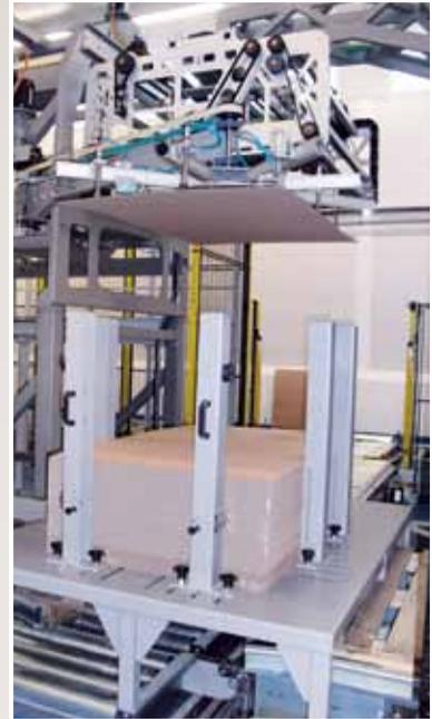
上述的产品包然后被Smiline输送带继续输送到Smipal APS 3080 PR全自动码垛系统的入口，并通过该码垛系统放置在800x1200 mm和1000x1200 mm欧洲垛盘上。
