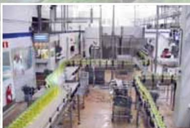
在Smiform的ECOBLOC® 紧凑型系统的灌装模块上也应用了创新的技术方案，从而能够限制水和能源的消耗量。
