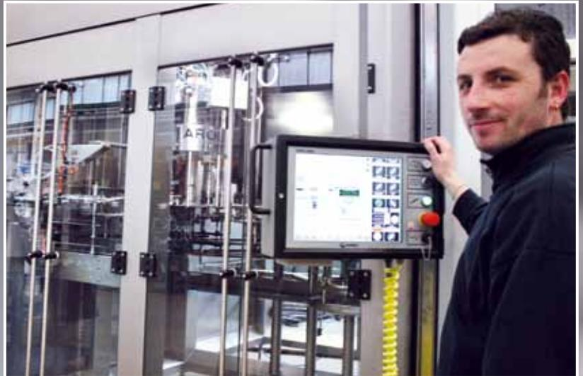
将安提瓜酿酒公司的Oasis矿泉水灌装到0.35升、0.65升和1.5升PET瓶中的一次包装由 Smiform的 ECOBLOC® 4-28-8 LG-VMAG 拉伸吹瓶、灌装/封盖一体机执行，而将产品裹包在带或不带平纸板垫的收缩膜中的二次包装，则由一台Smiflexi LSK 25 P型收缩膜包装机执行。
