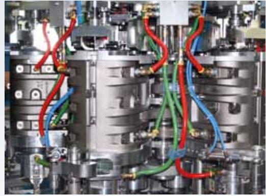
在新型Smiform吹瓶机上所采取的技术解决方案中值得一提的是，在拉伸吹瓶过程中用于夹住瓶坯并松开瓶子的夹头被整合到拉伸吹瓶站的内部结构中。
