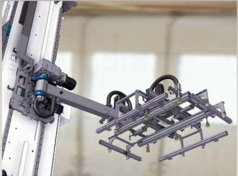
Smipal系统利用该空间安置管理垛盘流和插入中间垫层的机械装置。
