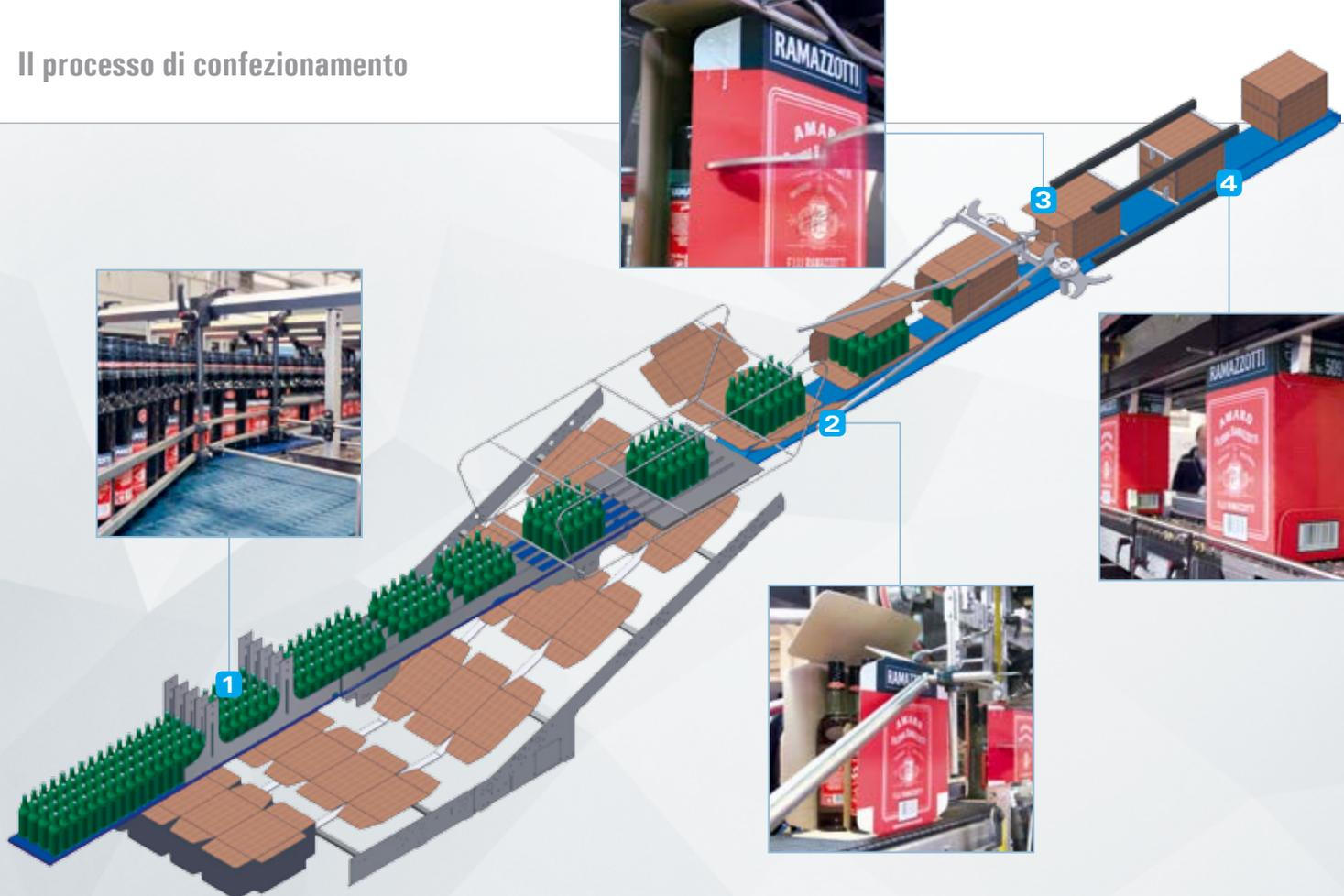
**1** Nella zona dell'ingresso macchina, un apposito gruppo di guide provvede ad incanalare correttamente i contenitori sfusi trasportati da un nastro con catene in materiale termoplastico a basso coefficiente d'attrito. Nella zona di formazione del pacco, i contenitori vengono raggruppati in modo continuo nel formato desiderato per mezzo di pioli e barre di separazione sincronizzati elettronicamente.
