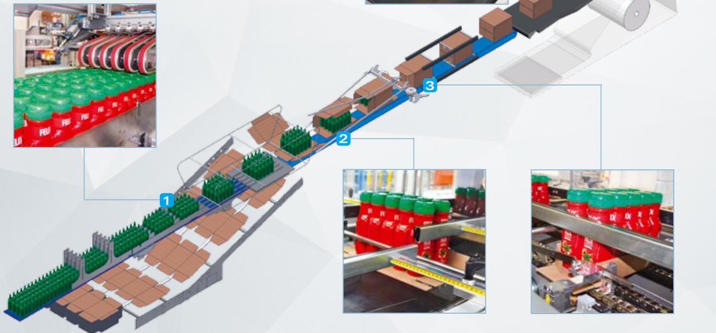
**1** Nella zona dell'ingresso macchina, un apposito gruppo di guide provvede ad incanalare correttamente i contenitori sfusi trasportati da un nastro con catene in materiale termoplastico a basso coefficiente d'attrito. Nella zona di formazione del pacco, i contenitori vengono raggruppati in modo continuo nel formato desiderato per mezzo di pioli e barre di separazione sincronizzati elettronicamente.
