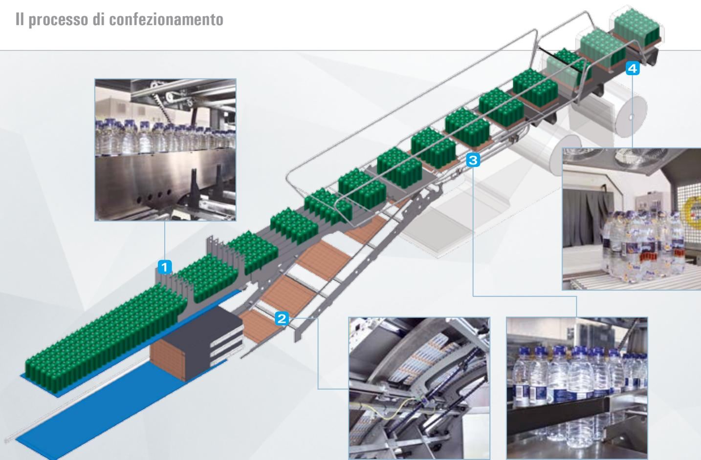
**1** Nella zona dell'ingresso macchina, uno smistatore oscillante provvede ad incanalare correttamente i contenitori sfusi trasportati da un nastro con catene in materiale termoplastico a basso coefficiente d'attrito. Nella zona di formazione del pacco, i contenitori vengono raggruppati nel formato desiderato tramite pioli e barre di separazione sincronizzati elettronicamente.
